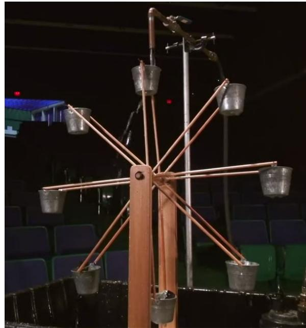
FIGURE 3.6 – Moulin de Lorenz réalisé par l'université de Harvard
