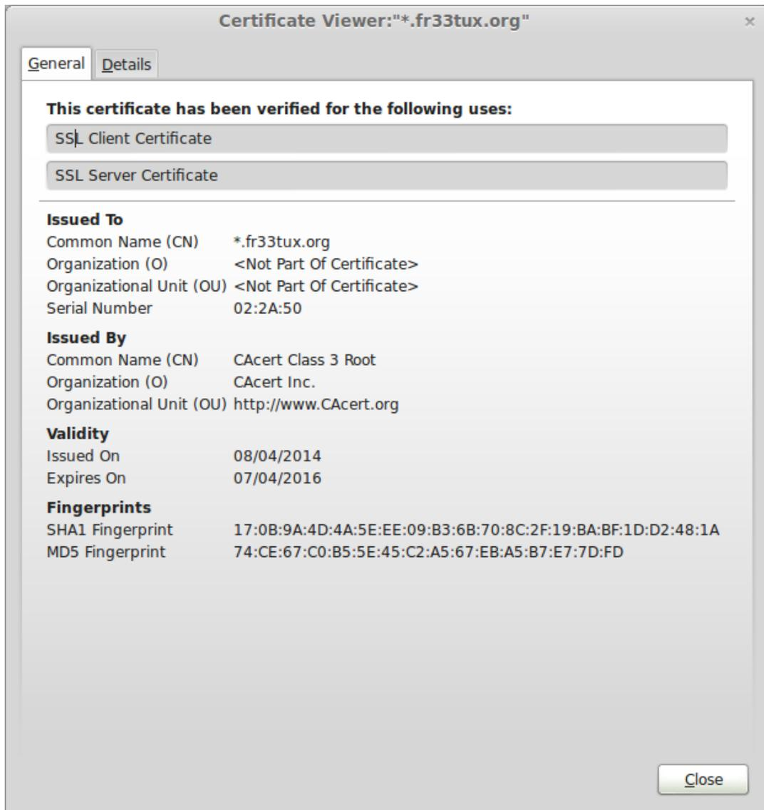
FIGURE 2 – Exemple d'un certificat à la norme X.509 tel qu'affiché dans le navigateur Mozilla Firefox
